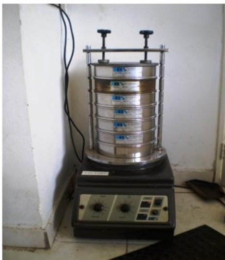
Figura 14: Peneirador vibratório para separação mecânica dos grãos de sedimento.
